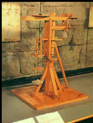
Lo spostamento del peso in senso verticale e orizzontale è effettuato mediante viti e contrappesi. Deriva da una simile macchina usata dal Brunelleschi nella costruzione della cupola di Santa Maria del Fiore.
