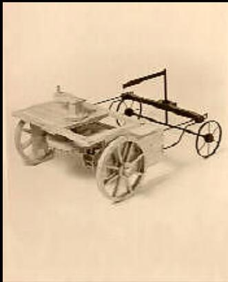
*Sistema di trasmissione del moto a un assale di carro. Una manovella aziona la ruota dentata che ingrana un rocchetto a lanterna, a sua volta impegnato sull'asse portante le ruote.*
