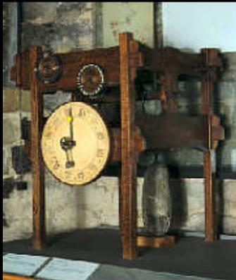
**Il modello integra il disegno originario con la struttura portante e i quadranti per minuti d'ora, ore, fasi della luna.**
