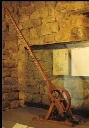
**Scala allungabile tramite ruote dentate e vite senza fine, montata su cavalletto.**
