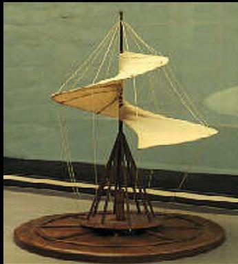
La macchina è costituita da una spirale di tela avvolta su un albero verticale. Manca, in Leonardo, ogni indicazione sul sistema di rotazione e di sollevamento.
