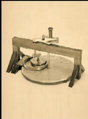
La pagina è tutta dedicata alle macchine per la lavorazione degli specchi. Il disegno corrispondente al modello ricostruito è il terzo dall'alto coi due assi rotanti. I piatti circolari ruotanti assicurano la perfetta levigazione della superficie dello specchio. Il minore ha due movimenti: di rotazione sul proprio asse e di rivoluzione sul piatto maggiore.
